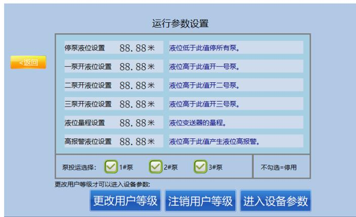
从泵站控制系统画面点击参数设置按钮进入此画面。停泵液位设置，在屏上自动模式下当液位低于此值时会停止所有泵的运行。一泵开液位设置，在屏上自动模式下当液位高于此值时会启动一号水泵。二泵开液位设置和三泵开液位设置与上面相似。液位量程设置，按照液位变送器上的量程最大值来设置。泵投运选择，勾选的泵会正常启停，不勾选的泵处于停用状态，不会启动。
