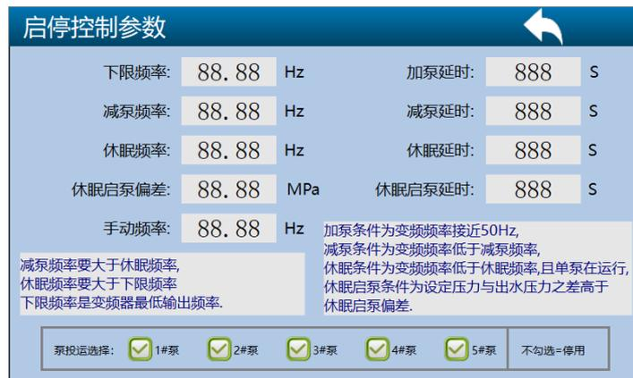
在参数设置选择画面进入启停控制参数画面。启停控制参数在自动模式下才起作用。下限频率是输出变频器频率的最低频率，目的是保证水泵有足够的转速，根据经验来设置。系统一开始会启动1台泵，当变频器频率高于49Hz，经过加泵延时后，会加开1台泵。如果变频器频率还是高于49Hz，经过延时会再加开1台泵，以此类推。当变频器频率低于减泵频率时，经过减泵延时，会减1台泵。系统会选择最先启动的那台泵来减泵，加泵时也是类似逻辑，会选择最先停止的那台泵加泵。
