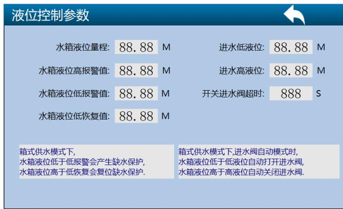
在参数设置选择画面进入液位控制参数。在箱式供水模式下液位参数才有效，无负压供水模式不需要设置液位参数，箱式供水和无负压供水的选择，在设备参数中的功能选择参数中设置。
