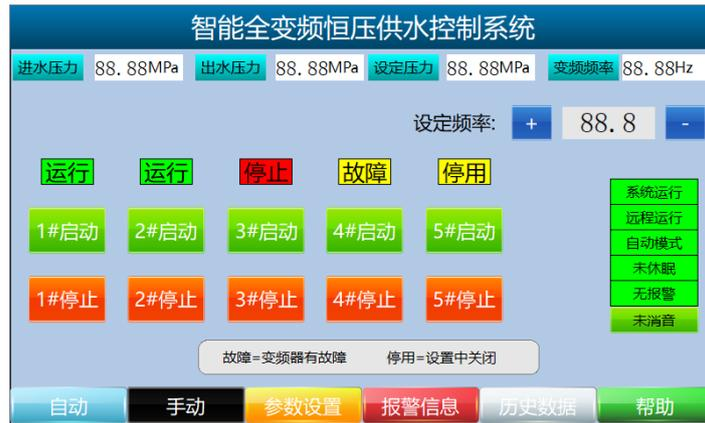
点击下部的手动按钮,会出现一个信息提示,点击是进入手动模式,首先会复位所有泵的输出。在手动模式下,可以点击启动按钮来启动泵,点击停机按钮来停止泵,可以设置变频器频率。手动模式不执行 PID 运算,不能自动调节变频器频率,只能设置为固定值。手动模式主要用来调试的。注意手动模式下也有可能进入休眠模式,可以查看一下参数设置里面的设置。
