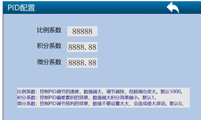
从设备参数选择画面，进入此画面。PID 运算根据设定压力和出水压力以及设置参数来得出变频频率，达到恒压供水的目的。PID 计算有三个部分组成，比例项、积分项、微分项。比例系数对三个部分都起作用，比例系数大，变频频率调节的速度加快。积分系数是一个分母，积分系数越大，积分效果越小，积分效果使出水压力逼近设定压力。微分系数越大微分效果越大，微分效果起一定预调节作用。
