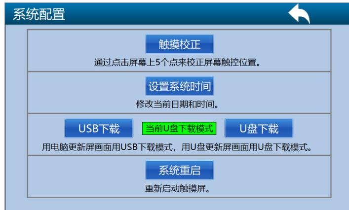
从设备参数选择画面,进入此画面。触摸屏校正就是通过点击屏幕上 5 个点来校正屏幕触控位置，如果屏幕上画面和实际可点击位置出现较大偏差，可以用此功能来校正。
