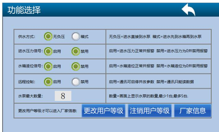
从设备参数选择画面，点击相应按钮进入此画面。无负压供水是指进水管路直接接入水泵的供水方式，这种方式可以利用进水压力的能量，减少加压耗电量，常配置进水压力变送器和进水压力电接点压力表。箱式供水模式是指进水先流入一个储水水箱，然后水泵再从水箱抽水加压的供水方式，这种方式在进水供水中断时仍能维持一定量的供水，一般配置水箱液位变送器，而不配置进水压力电接点压力表，有时候会配置水箱进水电动阀。
