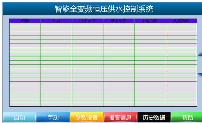
点击画面底部的历史数据，进入此画面。本系统会记录出水压力、进水压力、水箱液位、变频频率的数值，每 1 分钟记录 1 次，可以存储 30 天的数据。可以通过右侧的上下翻页按钮来查看更多数据。历史数据帮助排查故障细节。
