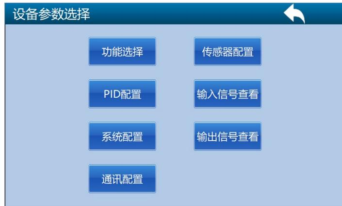
从参数设置选择画面的设备参数，进入密码输入界面，输入正确密码后进入设备参数选择画面。如前所述，进入设备参数需要用户等级 2 级，用户等级 2 级的密码是 1212。设备参数里面是一些一般不需要最终用户来调整的参数，点击相应的按钮进入各个分项的设备参数画面。设置完成之后，可以退回到密码输入界面，点注销用户等级，来使用户等级回到 1 级。
